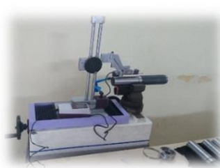
Hình 5.15 Đo độ nhám bề mặt mẫu thí nghiệm
