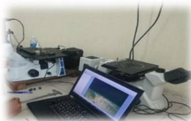
Hình 5.16 Quá trình đo mòn dao
