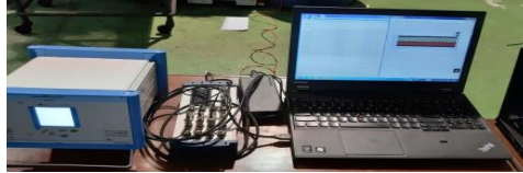
Hình 5.12 Đo lực cắt tiện cứng
