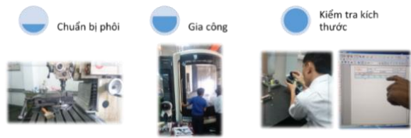
Hình 5.7 Quy trình gia công các chi tiết đồ gá thay đổi góc dao
