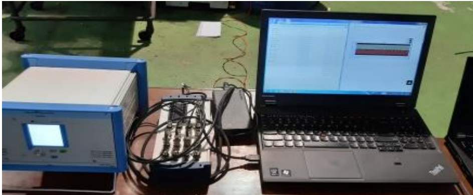
Hình 5.12 Đo lực cắt trong tiện cứng
