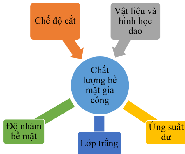
Hình 3.7 Ảnh hưởng của thông số gia công và dụng cụ cắt đến chất lượng của bề mặt gia công trong tiện cứng
