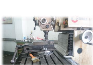
Hình 5.7 Quá trình gia công hệ thống đồ gá thay đổi góc dao
