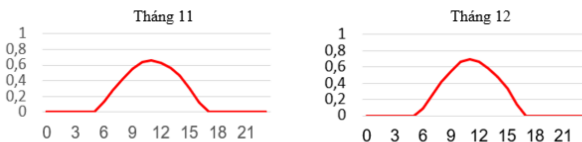
Hình 4.38. Công suất phát điển hình tháng 11 và tháng 12 của hệ thống điện mặt trời áp mái tại đảo Phú Quý theo đơn vị tương đối.
