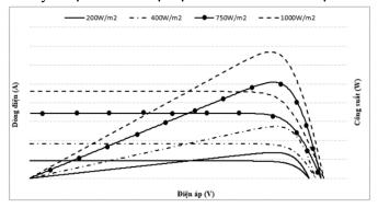
Hình 2. Đặc tuyến I-V và P-V khi thay đổi bức xa
