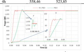
Hình 8. So sánh hai giải pháp MPPT trong điều kiện tiêu chuẩn
