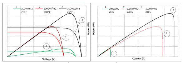
**Hình 1.** Đặc tuyến P-V, I-V và P-I khi thay đổi bức xạ và nhiệt độ
