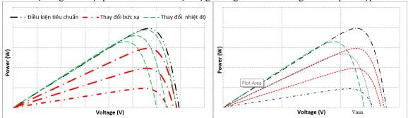
Hình 2. Đặc tuyến P-V khi thay đổi: a: bức xa hoặc nhiệt độ; b: cả bức xa và nhiệt đô
