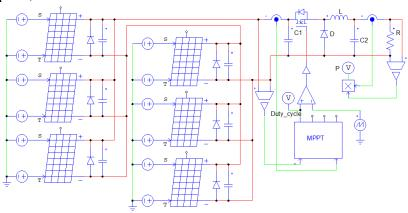
Hình 5. Cấu trúc hệ thống mô phỏng trong PSIM
