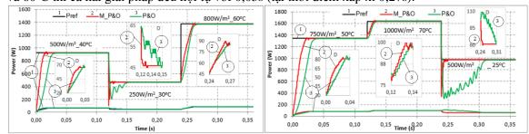
**Hình 11.** So sánh MPPT khi thay đổi cả bức xạ và nhiệt độ
